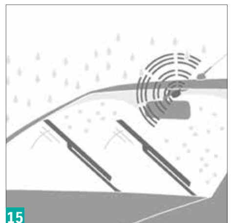
15 | Czujnik deszczu automatycznie kontroluje pracę wycieraczek przedniej szyby – od idealnie dobranej pracy przerywanej, po pierwszy zakres pracy ciągłej
